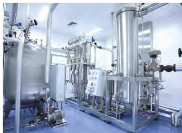
Speziell angepasste Erhitzer kommen in der Pharmazie und in der Lebensmitteltechnik zum Einsatz.
